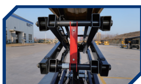
安全检修支架
